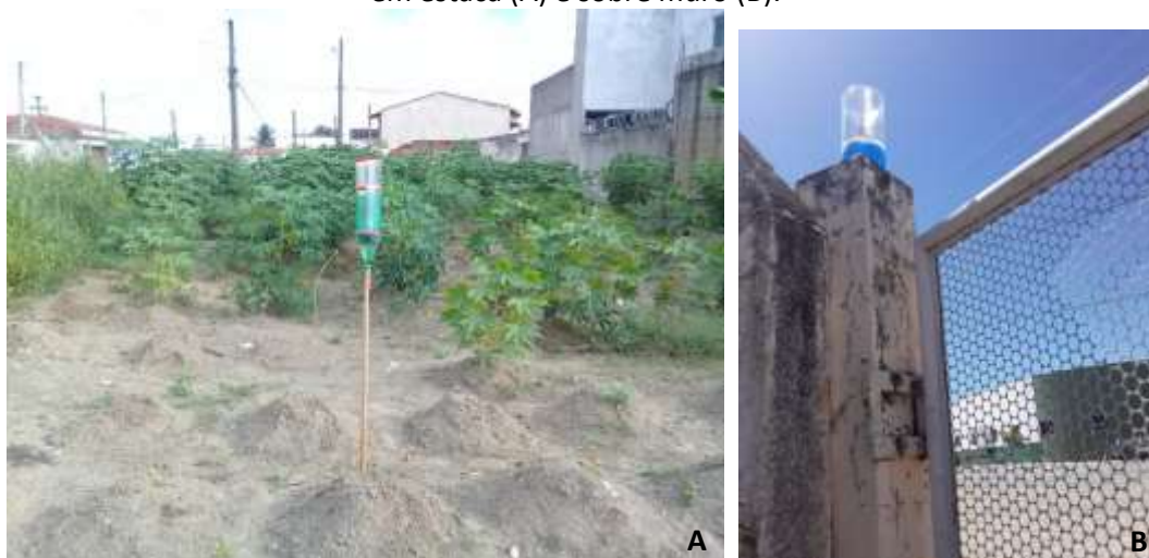
Figura 4. Pluviômetro artesanal instalado em diferentes locais: em estaca (A) e sobre muro (B).
