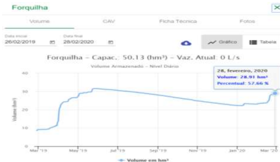
Figura 7 – Volume do Açude Forquilha em fevereiro de 2020.
