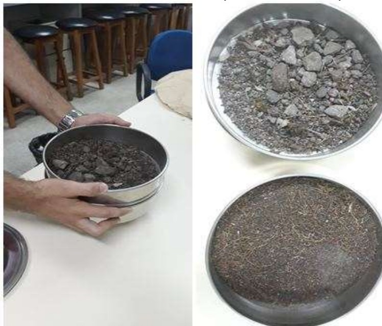
Figura 2 – Amostra de solo sendo selecionada por meio de uma peneira granulométrica.
