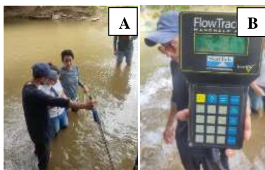
Figura 3: A- Vazão na seção Transval do rio Acaraú; B- Leitura da vazão
