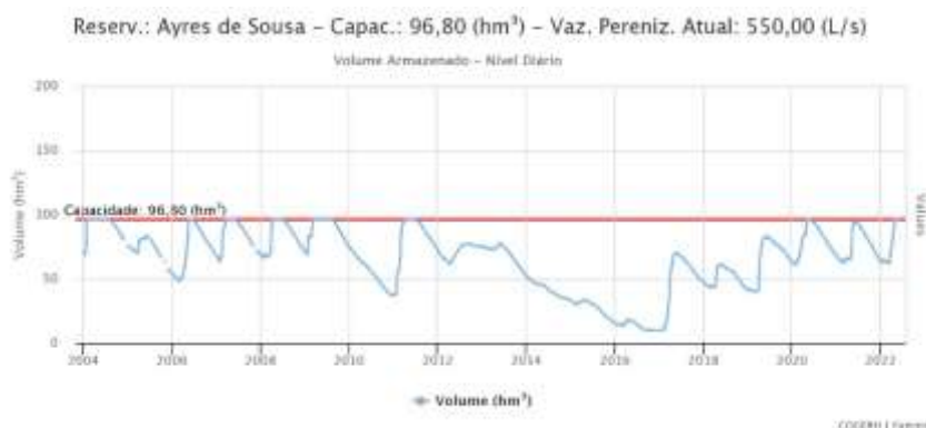
Gráfico 1: Capacidade do reservatório
