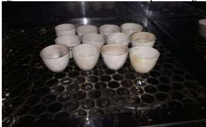
Figura 3 – Amostras de solos na estufa para a secagem.
