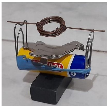
Figura 1: Primeiro Modelo de Motor Eletromagnético desenvolvido para teste.
