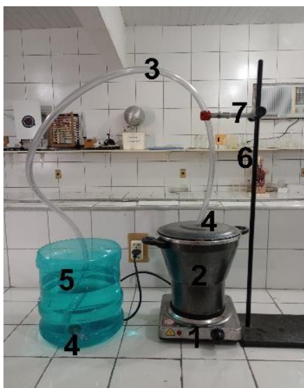
Figura 2. Fotografia digital do sistema de extração alternativo de óleo essencial.
